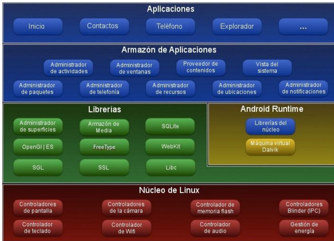
Figura 2: Arquitectura interna de la plataforma Android, tomado de la ayuda de Android.
