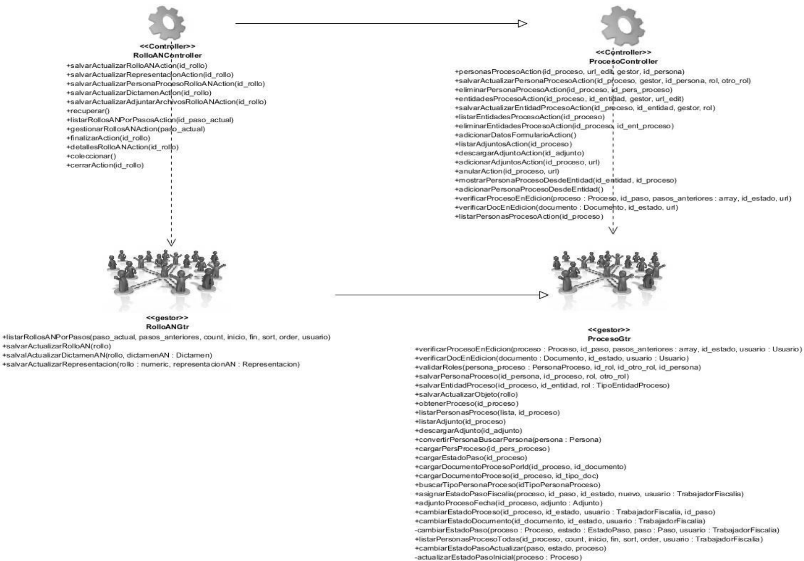
Figura 5. Diagrama de clases controladoras y gestoras para Asuntos Notariales.
