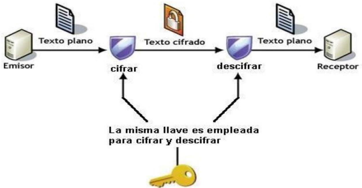
**Ilustración 17** Proceso de encriptación con llave simétrica.
