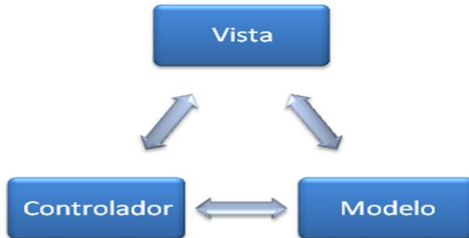
Figura 4: Diagrama del Patrón Arquitectónico MVC
