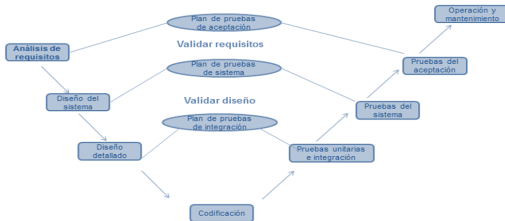
Figura 10. Modelo V. Permite realizar pruebas a lo largo del ciclo de desarrollo del software.
