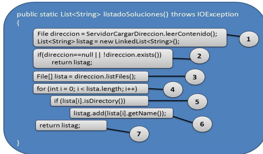
Figura 16. Función que lista las soluciones existentes en el sistema. Está dividido por bloques enumerados que representan los nodos del camino básico.
