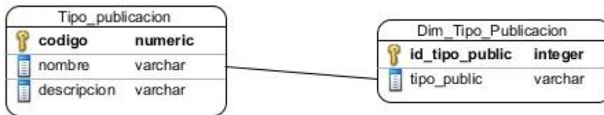
Figura 16: Diseño de la ETL la dimensión Dim_Tipo_Publicacion.
