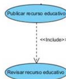
Fig. 1.10 Ejemplo del patrón Inclusión concreta.
