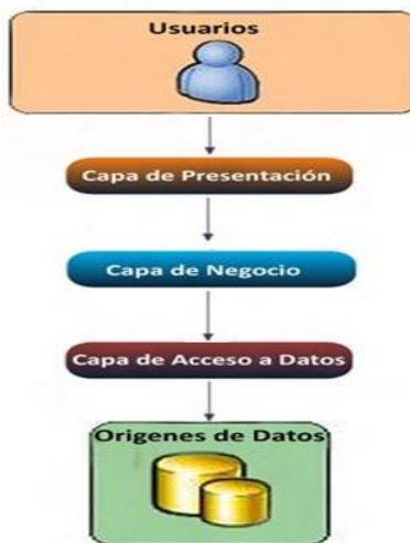
Figura 4: Arquitectura del Sistema.
