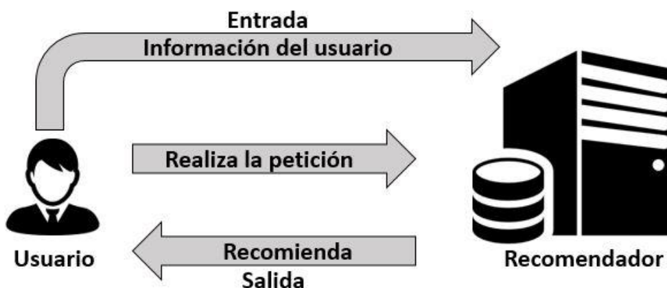
Figura 2. Estructura de un Sistema de Recomendación. Elaboración propia
