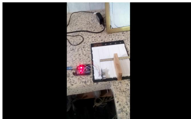
Figura N°11: Prueba de Placa Arduino conectada a Ordenador y Módulo Ultrasónico Hc Sr04 para determinar tiempo de tránsito. (Fuente: Autor, 2018).
