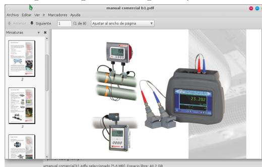
Figura N°7: Medidor de Flujo Ultrasónico Comercial. (Fuente:Dynasonics)
