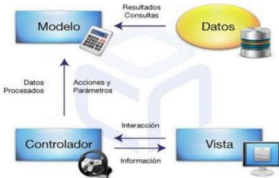
Fig. 15: Funcionamiento MVC.
