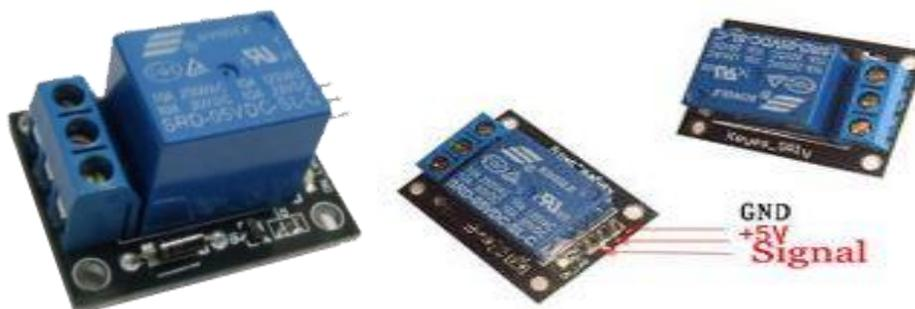
Figura 8. Módulo de relés para Arduino
