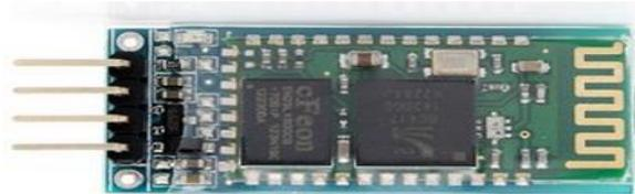
Figura 9. Módulo de Bluetooth HC-06 para Arduino
