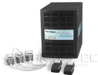
Figura 6: Dispositivo de seguimiento magnético (Polhemus Liberty) [67].
