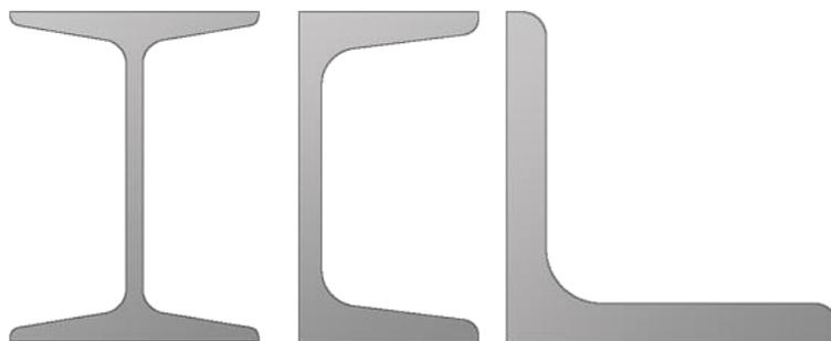
*Figura 2 Ejemplo de perfiles I,C,L.*
