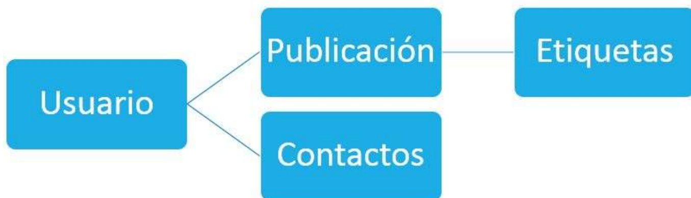
Figura 14 Base de datos mapeada como grafo por el algoritmo BFS
