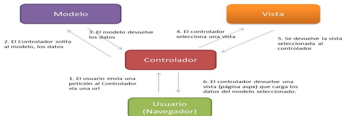
Figura 9. Funcionamiento de una aplicación con MVC.
