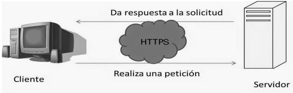
*Ilustración 2. Esquema Arquitectura Cliente-Servidor (26).*
