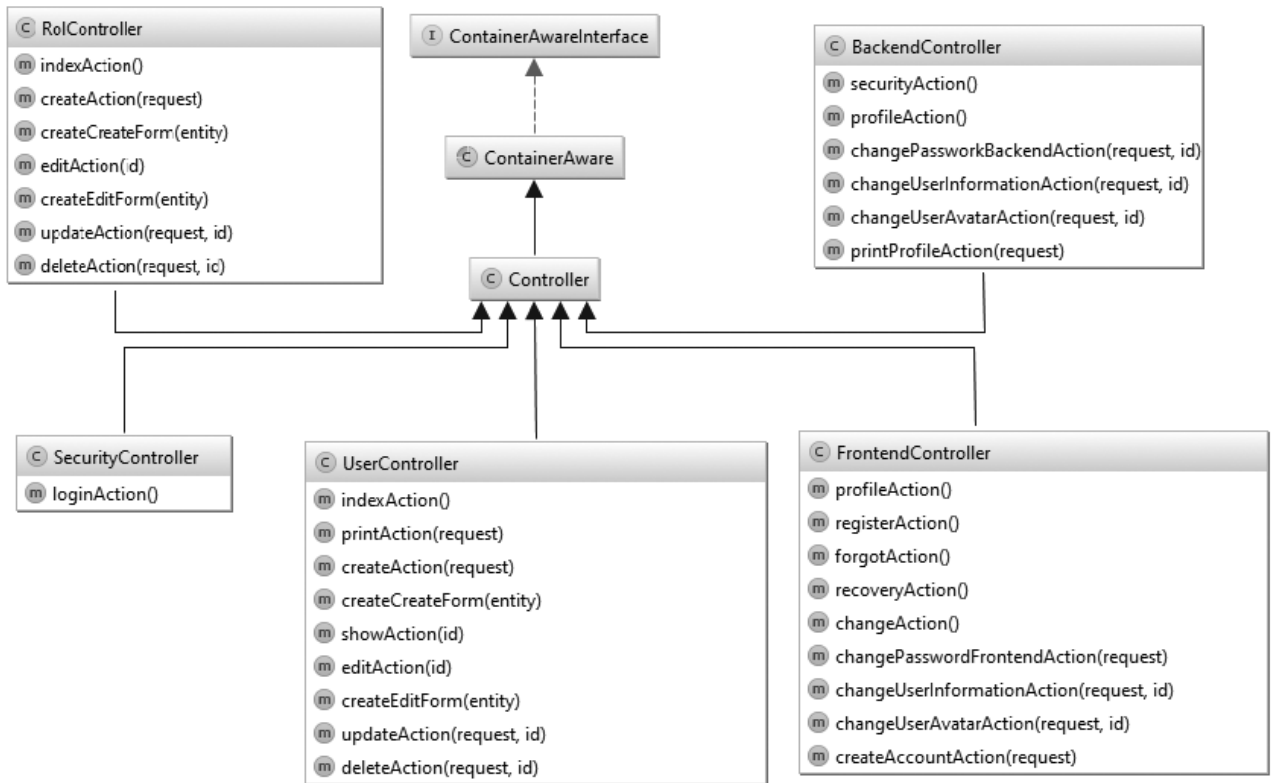
Ilustración 13: Fragmento del diseño de clases del módulo seguridad.
