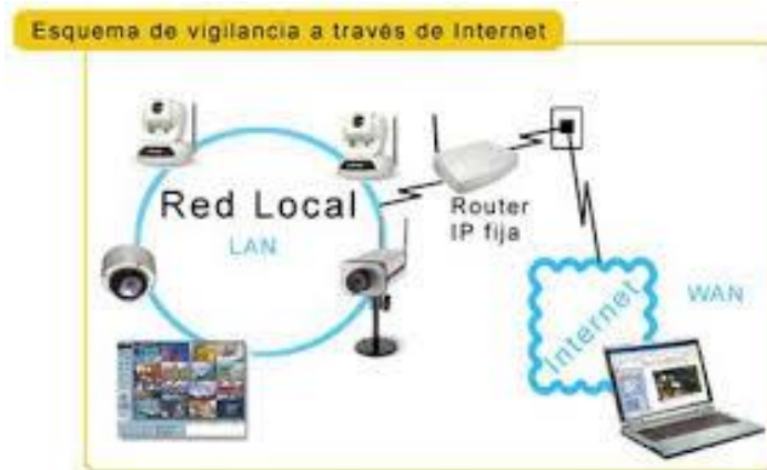
Ilustración 4. Esquema del funcionamiento de las cámaras IP
