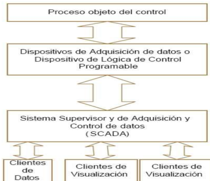
Figura 2: Esquema básico de un sistema SCADA.
