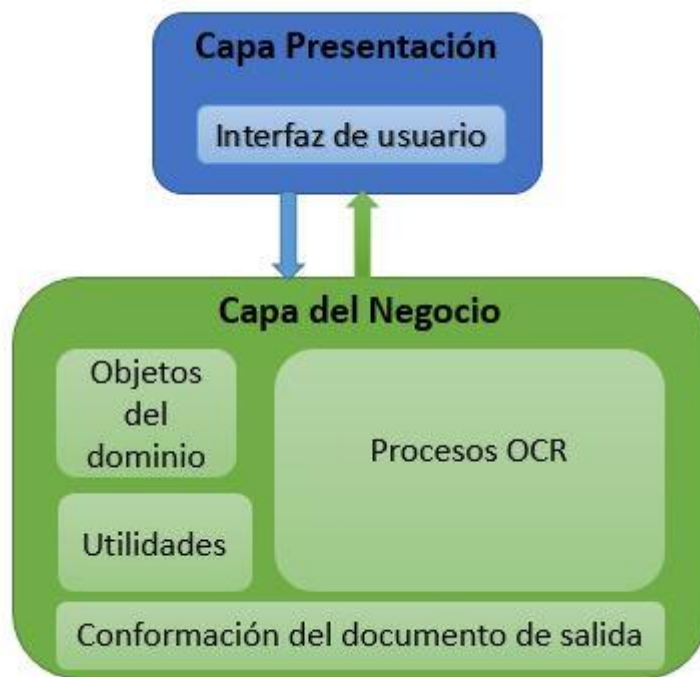
Ilustración 15 "Arquitectura del sistema"
