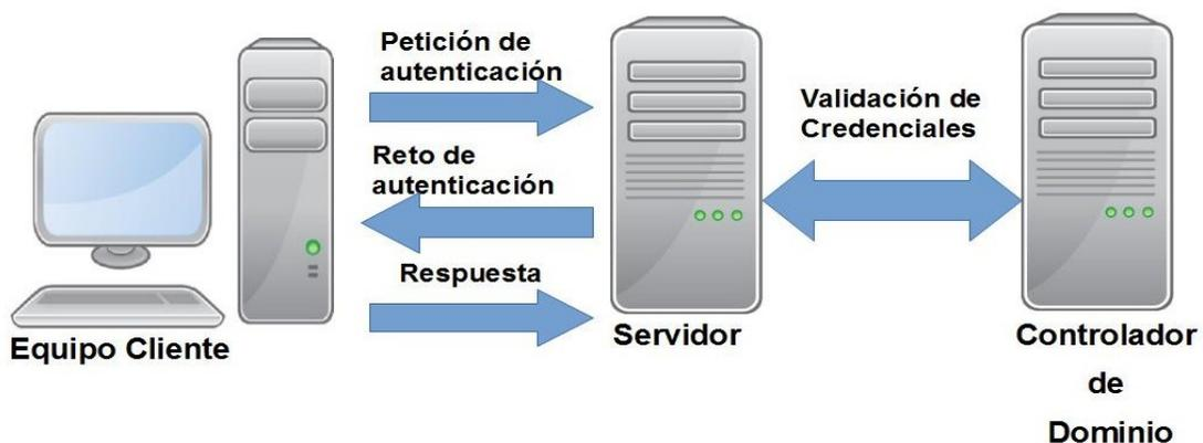
Ilustración 2: Proceso de autenticación NTLM
