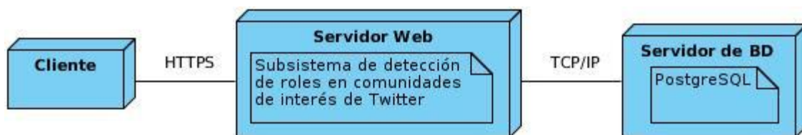
Diagrama 3.2. Modelo de despliegue (Elaboración propia).
