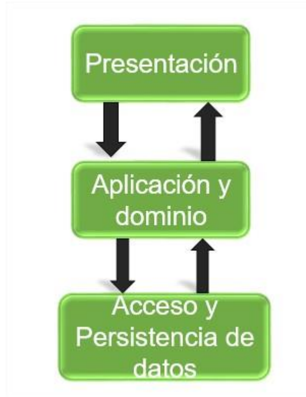
Figura 1 Arquitectura de la plataforma Nova ARST
