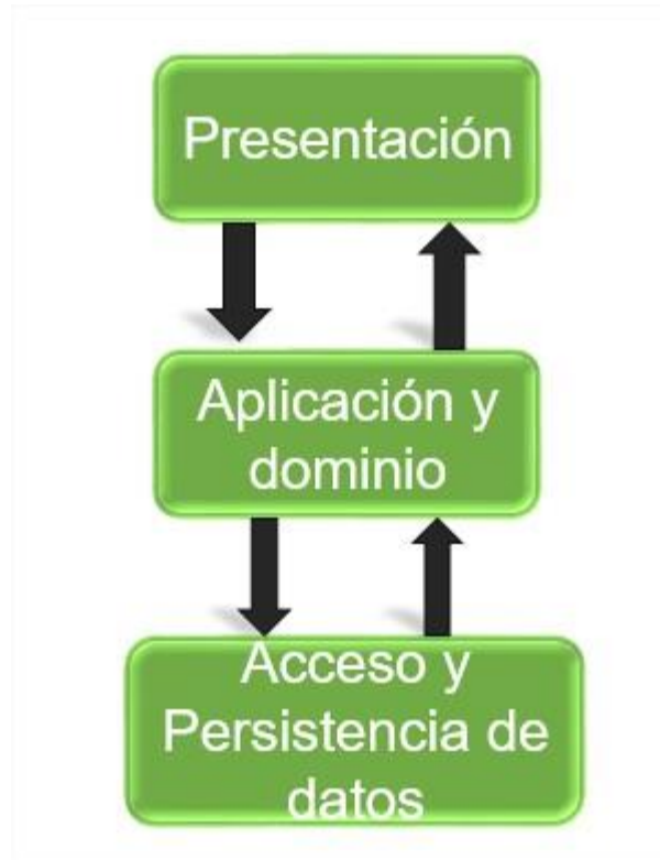
Figura 3 Arquitectura del módulo
