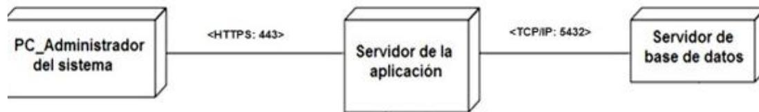
*Figura 8 Diagrama de Despliegue*
