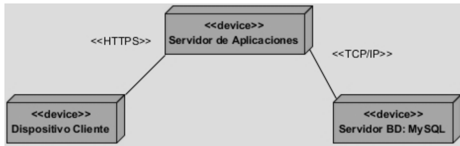
Figura 14. Modelo de Despliegue
