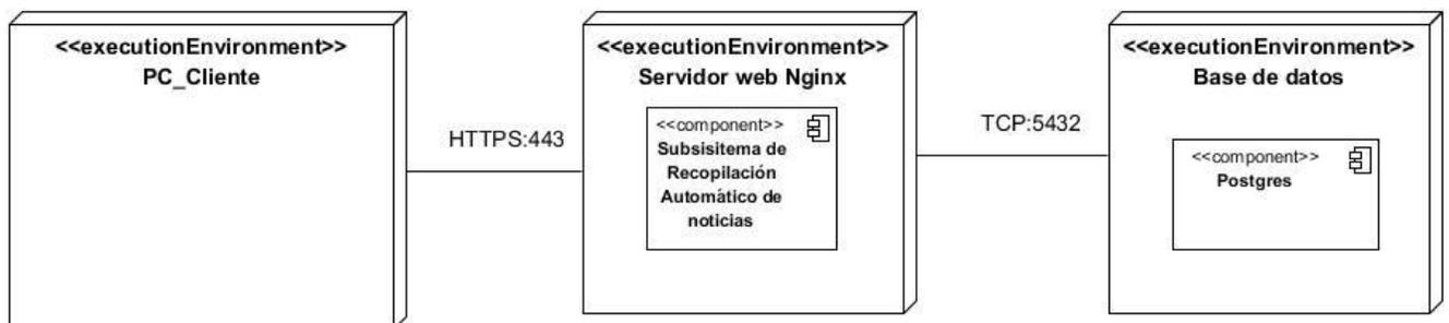
Figura 8. Diagrama de despliegue del subsistema de recopilación automática de noticias (Elaboración propia)
