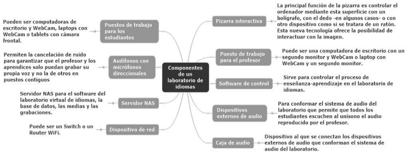
Fig. 1 Componentes de un laboratorio de idiomas[13, 14]
