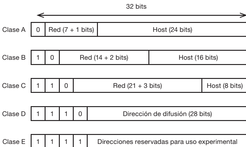
Fig. 3.11. Estructura de los bits para las direcciones IP de las redes de clase A, B, C y D. Las direcciones de clase E están reservadas para aplicaciones futuras o para uso experimental.
