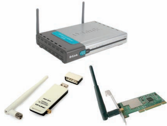
Fig. 2.2. Dispositivos inalámbricos utilizados en redes de área local: punto de acceso con doble antena (arriba), tarjeta de red inalámbrica con interfaz USB (abajo, a la izquierda) y tarjeta de red PCI con interfaz inalámbrica de una única antena (abajo, a la derecha).
