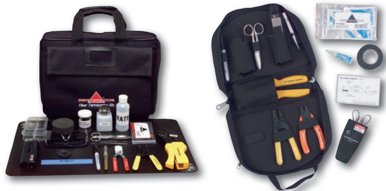
Fig. 2.6. Kits de conectorización de fibra óptica (a la izquierda) y de cables de pares (a la derecha).
