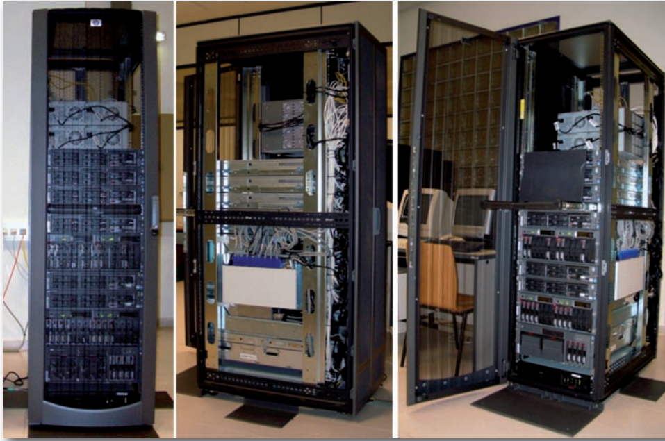
Fig. 1.1. Tres vistas de un armario de servidores. En el centro, vista lateral con las puertas del armario desmontadas para facilitar la instalación. A la izquierda y a la derecha, dos vistas frontales.
