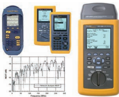
Fig. 2.24. Ejemplos comerciales de instrumentos utilizados en la certificación del cableado. En la parte inferior, gráfico ilustrativo de la medida del parámetro NEXT.
