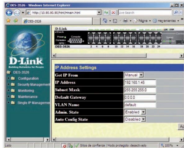
Fig. 2. Gestión del switch ETH1 mediante su dirección IP (arriba) y gestión de los dos puertos de la VLAN WAN (abajo).
