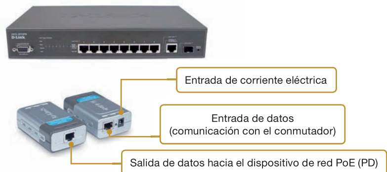
Fig. 2.13. Conmutador PoE (arriba) y adaptador PoE (abajo) para conmutadores no PoE (vista anterior y posterior)
