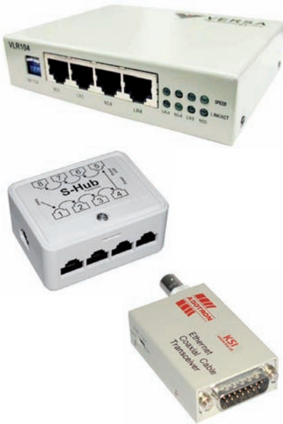
Fig. 5.16. Distintos modelos de repetidores. Hub doméstico (abajo, a la izquierda). Transceptor 10Base2/10Base5 (abajo, a la derecha). Obsérvese cómo el repetidor tiene en la parte superior una interfaz coaxial y en el frontal varios puertos RJ45 para intercambiar señales entre estos dos distintos tipos de red. El transceptor adecúa la señal de su canal coaxial al de pines.
