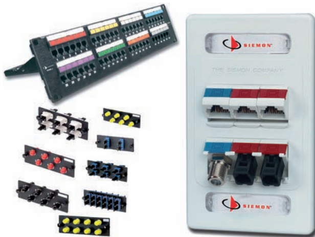
Fig. 2.16. Diversos modelos de elementos de conexión en armarios y canaletas. A la izquierda y arriba: bandeja de conexiones sobre la que se insertan los módulos de conectorización, que aparecen debajo. A la derecha, roseta de conexiones de múltiples servicios o usuarios, también denominado MUTOA (Multi-User Telecommunications Outlet Assembly).
