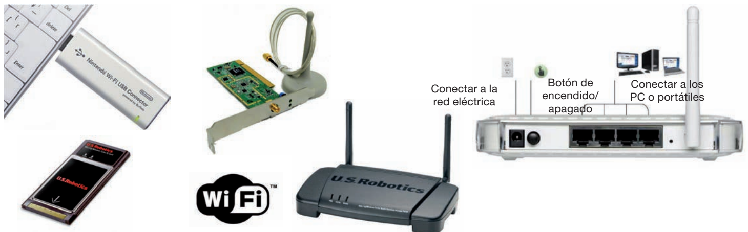
Fig. 7.5. Arriba, diferentes tarjetas de red con distintos modelos de interfaz de conexión: USB, PCMCIA y PCI. En el centro, logotipo identificador de la tecnología Wi-Fi. Abajo, puntos de acceso con especificación del fabricante sobre el modo de conexión a la red cableada.
