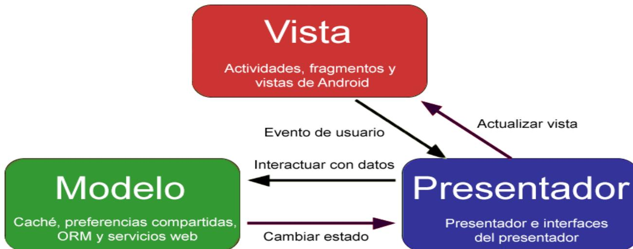
Fig. 16 Arquitectura de software Modelo Vista Presentador
