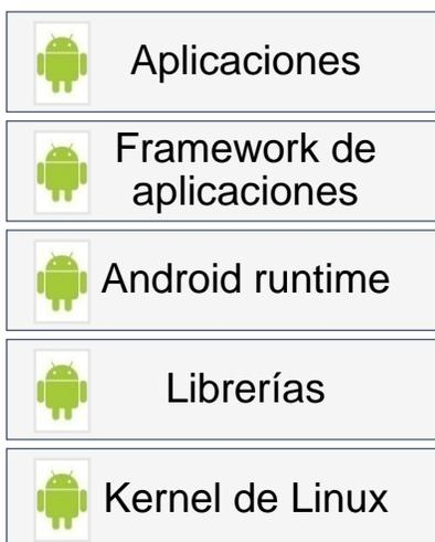
Fig. 3 Capas de la arquitectura del sistema operativo Android
