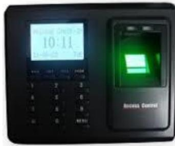
**Figura 2. Lector de huellas dactilares ZKTeco F702-S.**
