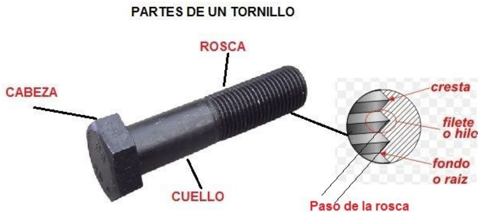
Figura 1.2. Partes del tornillo.
