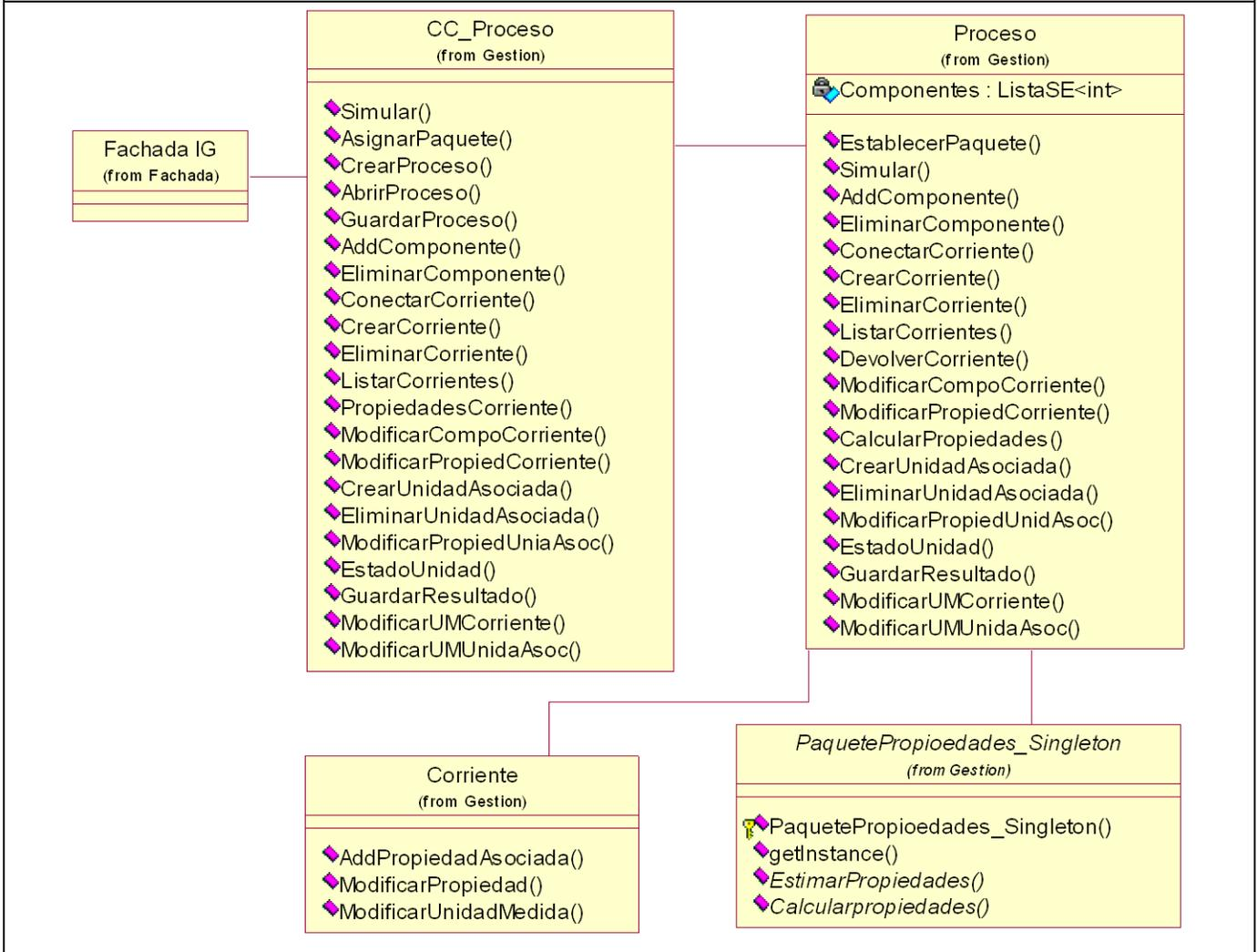
Figura 18 Diagrama de Clases del Diseño Caso de Uso: Calcular Propiedades
