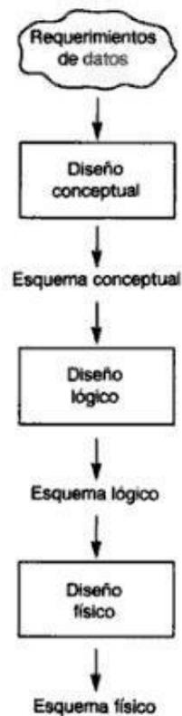
Fig. 1 Fases o Etapas del diseño de una base de datos.
