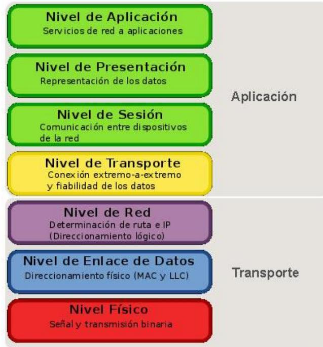
**Fig. 1 Capas del Modelo OSI**
