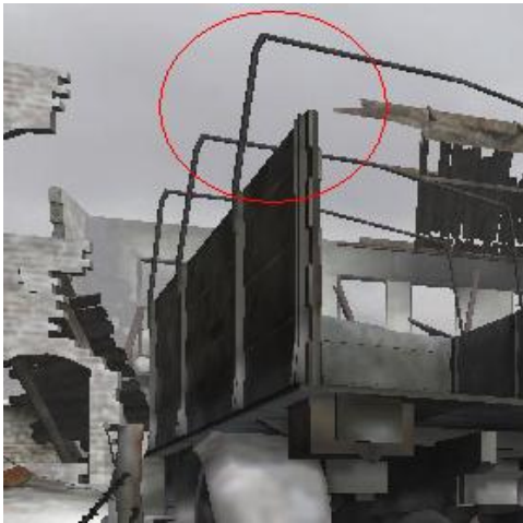
Fig 44 Imagen con aliasing. Se pueden apreciar claramente aristas en las varas del camión.
