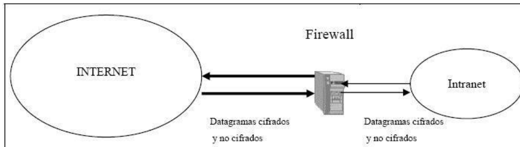
Figura 19 Esquema de seguridad basado en un firewall
