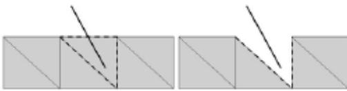
Fig. 1: Ejemplo de un tetraedro eliminado por colisión con la herramienta de corte.
