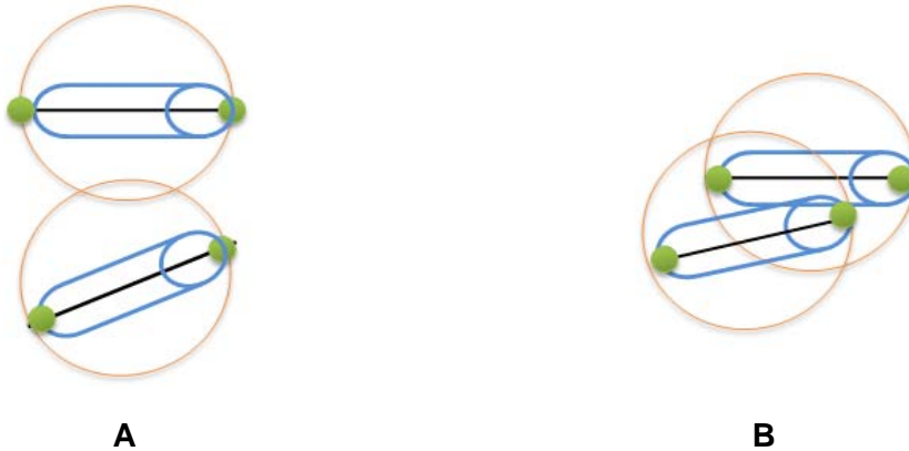
FIGURA 13: A: Falsa respuesta de colisión dada por BVH. B: Respuesta de colisión generada por cilindros.
