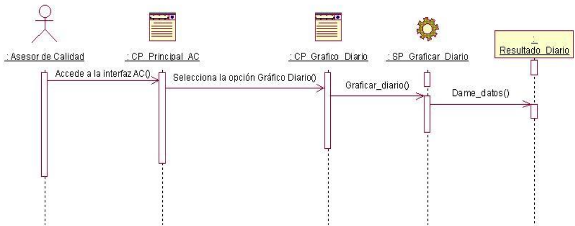
Figura 2.27 Diagrama de Secuencia del CUS “Realizar Control de las Observaciones” Escenario “Gráfico Diario”.
