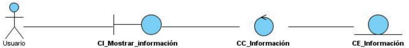
Figura 35: Diagrama de clases del análisis del caso de uso "Mostrar información"
