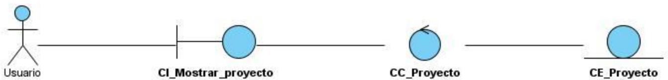
Figura 38: Diagrama de clases del análisis del caso de uso "Mostrar proyectos"
