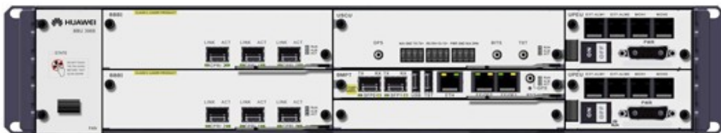
Figura 2.5: Tarjetas y módulos del BBU 3900
