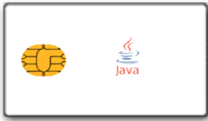
Figura 1.1: Ejemplo de Tarjeta Inteligente con contactos, una Tarjeta Inteligente está compuesta por un cuerpo de plástico y un circuito integrado (chip).
