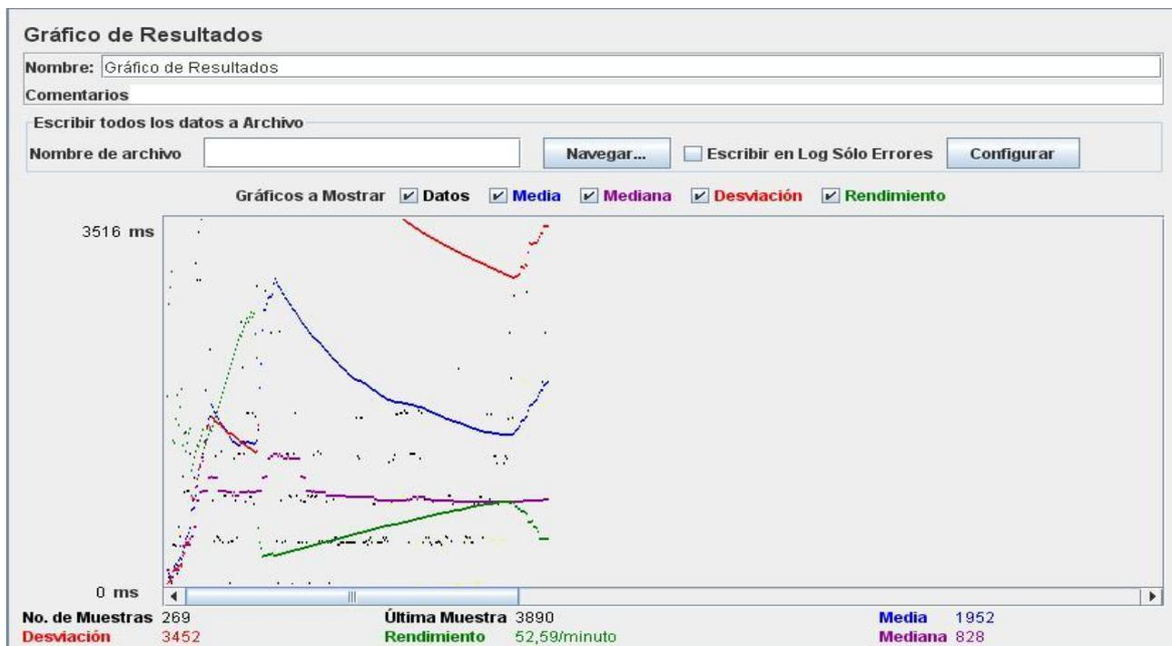
**Fig.8** Gráfico de resultados para la simulación de 50 usuarios con tiempo de subida de 10 segundos
