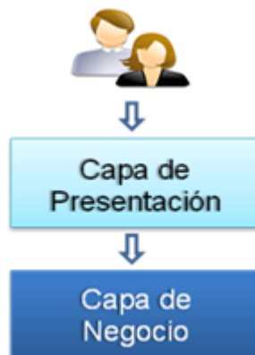
Ilustración 13. Patrón de arquitectura en capas
