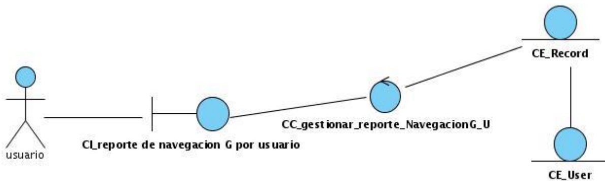
Fig. 17 Diagrama de clase de análisis: CU Reporte de navegación general por usuario
