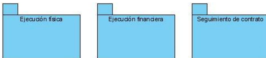
Figura 10: Representación del diagrama de casos de uso del sistema por paquetes de casos de uso.
