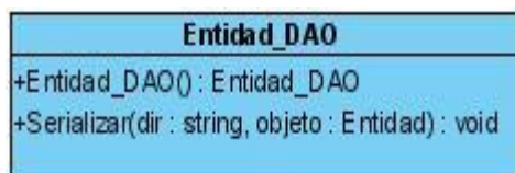
Figura 12 Diagrama de Clases de Diseño de la Capa de Acceso a Datos Sprint II.
