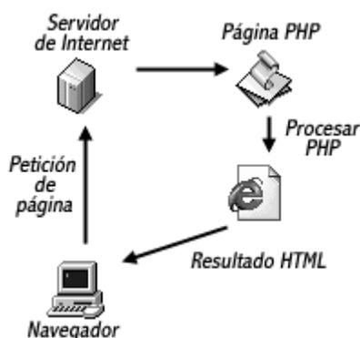
Figura 2. Esquema de representación del funcionamiento del PHP
